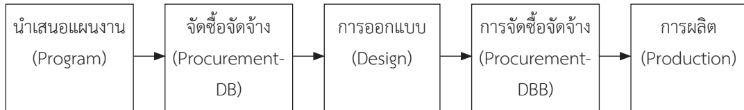
ภาพที่ 2 ลำดับขั้นตอนของโครงการก่อสร้าง
