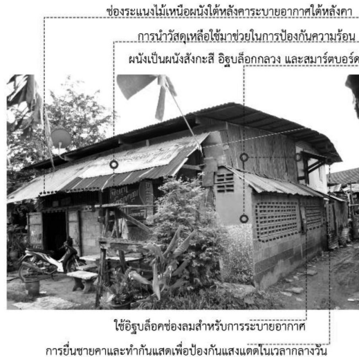
ภาพที่ 18 แสดงการใช้วัสดุอาคาร ช่องเปิดและการระบายอากาศ การใช้วัสดุเหลือใช้มาเป็นอุปกรณ์ป้องกันความร้อน
